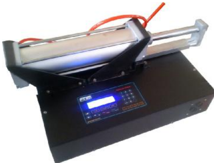
تصویر پمپ SP3000 (مدل دارای سیلندر 1 لیتری با قابلیت شارژ مجدد محلول)
