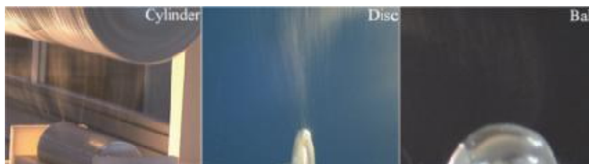
روش الکتروریسی در ریسنده سیلندری، دیسکی و توپی
